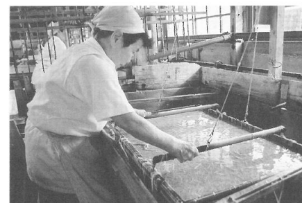
(写真1) 繊維が踊る和紙を漉く。舟上部の竹から3カ所つるされた桁杵に簾を入れ、簾の中に浮かぶ繊維の状態に目を凝らす。
