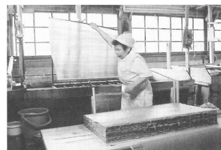
(写真2) 漉きあがったら、桁から簾だけを取り出し、舟後ろに積まれた完成和紙置き場に移動させる。
