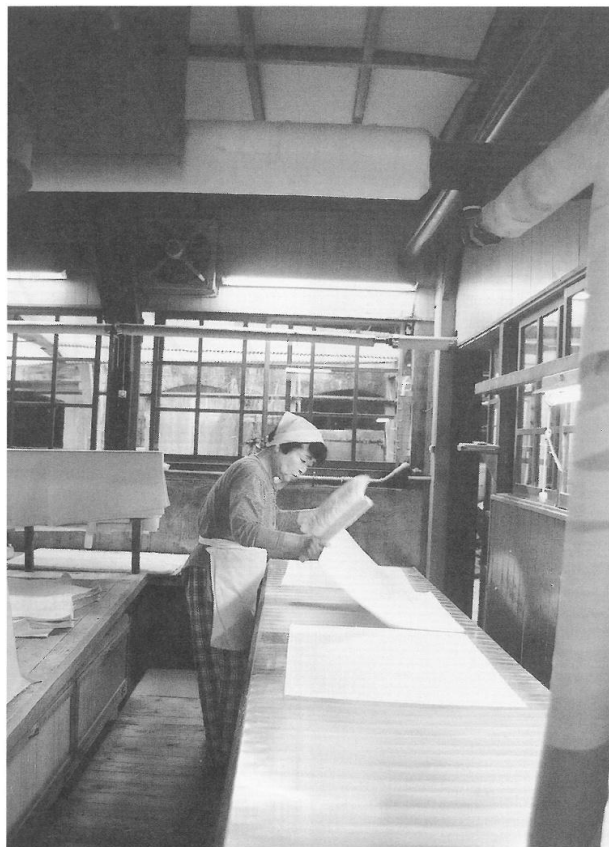
(写真4) 和紙の乾燥。三角柱のステンレス製乾燥機の上に、脱水した和紙を刷毛で丁寧に広げる。乾燥機を回転させ、一巡すると素早くはぎ取る。
